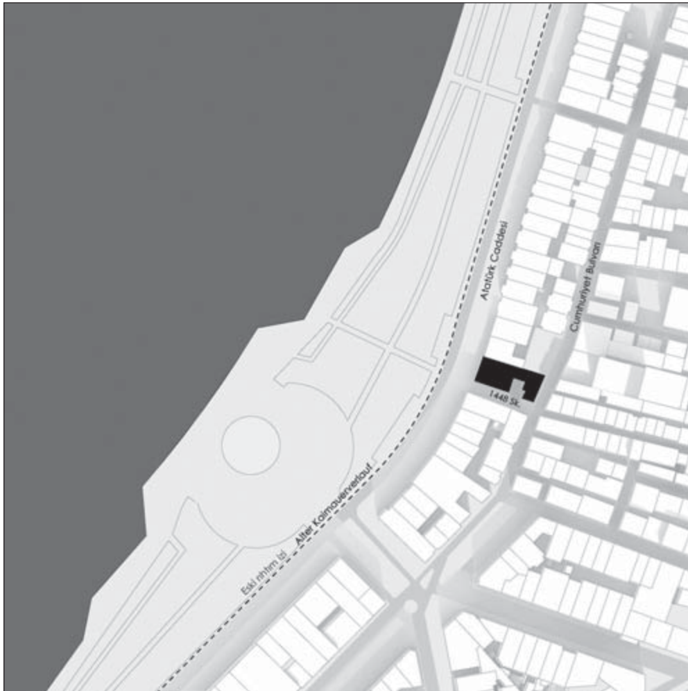
Abb. 2 Lageplan des Gebäudes am Kordon, die historische Uferlinie ist gestrichelt eingetragen, M. 1:3000
