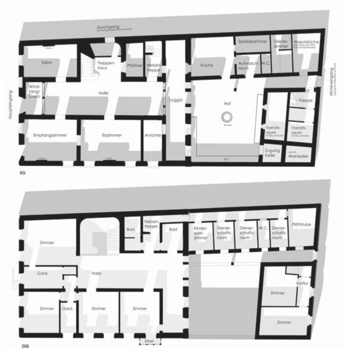
Abb. 3 Rekonstruierte Grundrisse des Erdgeschosses und des Obergeschosses des Palais Guiffroy auf Basis der Baudokumentation von 2012 und der Quellenangaben, M. 1:250
