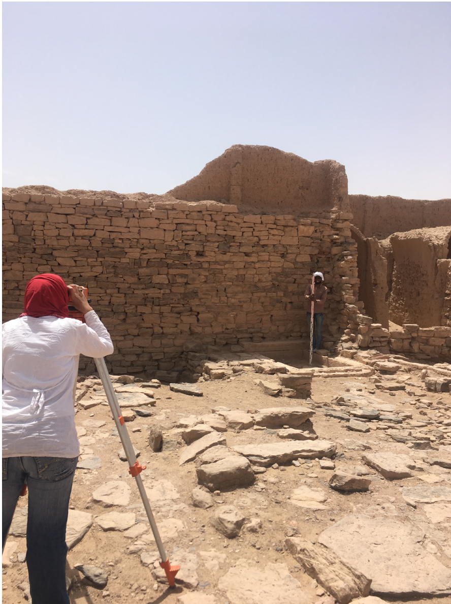
3 Nivellierübung im Rahmen der Fieldschool zur Dokumentation des Wasserversorgungssystems. (Foto: K. Czarnitzki, DAH-Projekt)
