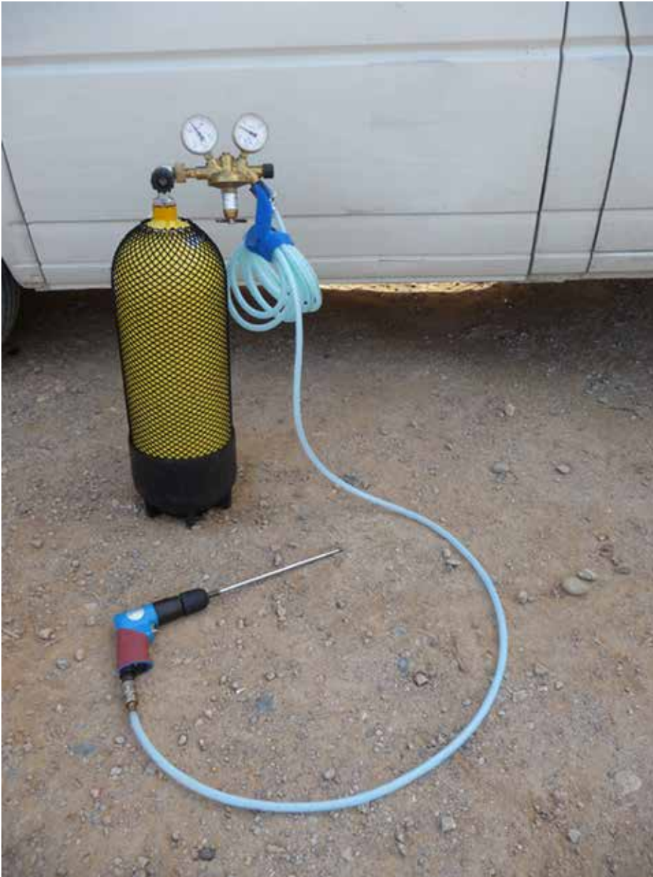
4 Das getestete System des pneumatischen Bohrers (Foto: M. H. Hermanns, DAI Madrid).
