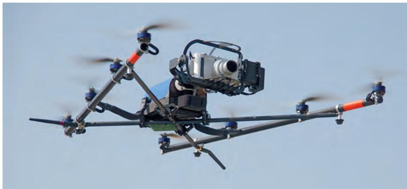
Abb. 6 Oktokopter mit Elektroantrieb für Luftaufnahmen mit Digitalkameras
