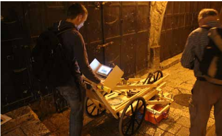
7 Nächtliche Georadarmessungen in der Jerusalemer Altstadt durch Ingenieure der TU Ilmenau (Foto: DEI Jerusalem).
