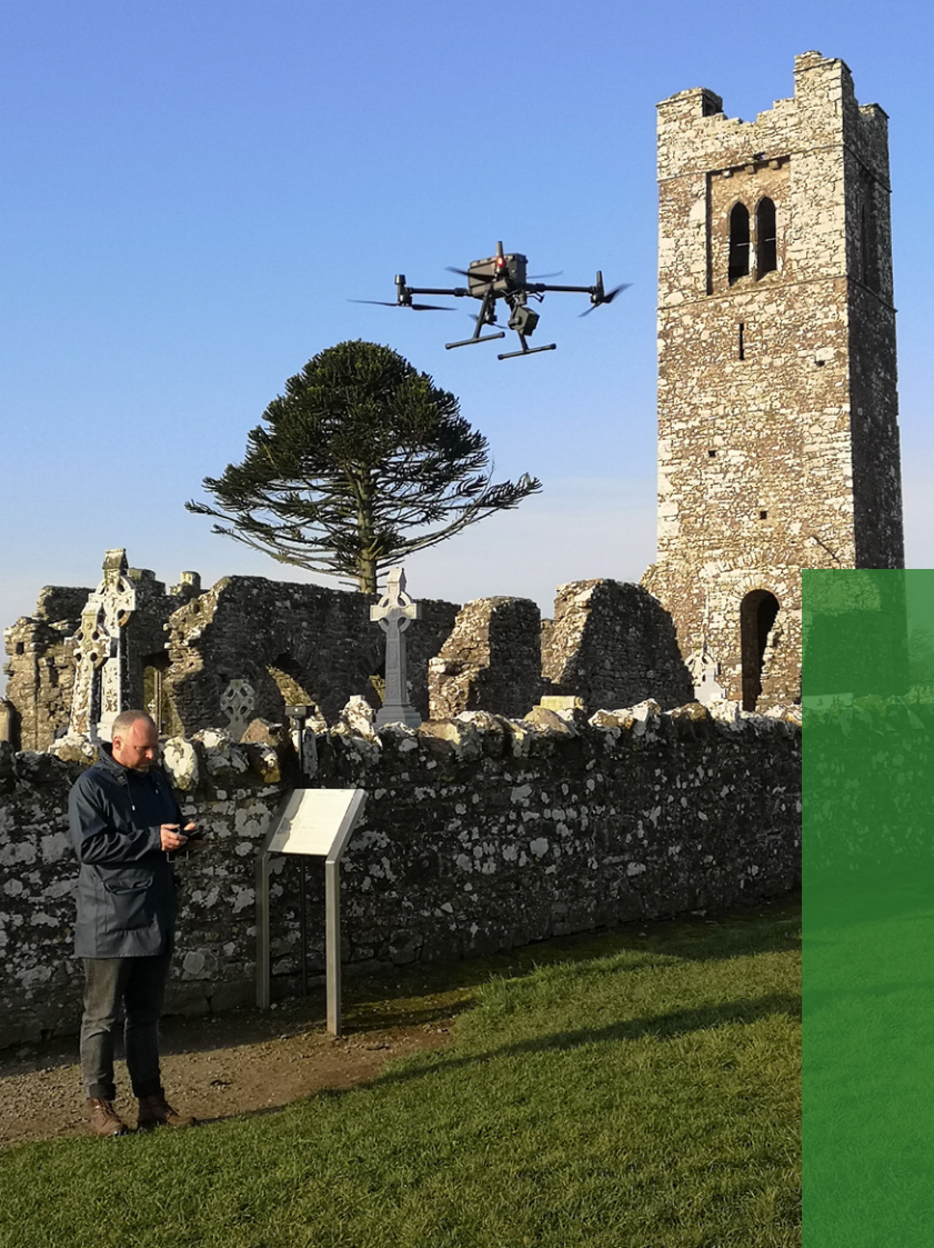
8 Die Drohne Matrice 300 mit dem LiDAR-Sensor Zenmuse L1 beim Einsatz auf dem Hill of Slane. Foto: Knut Rassmann, DAI
