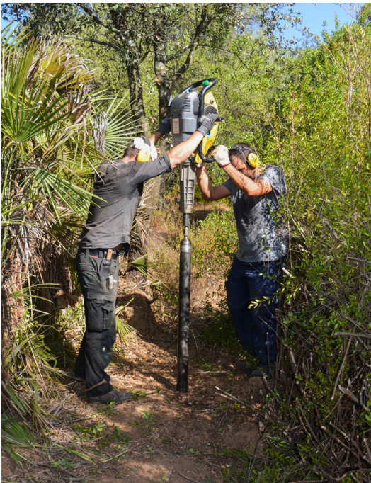
12 Munigua. Dehesa Alta 6. Rammkernsondage zur Erschließung eines Sedimentkerns im Bereich der römischen Stauanlage. (Foto: A. Kirchner/Universität Hildesheim)
