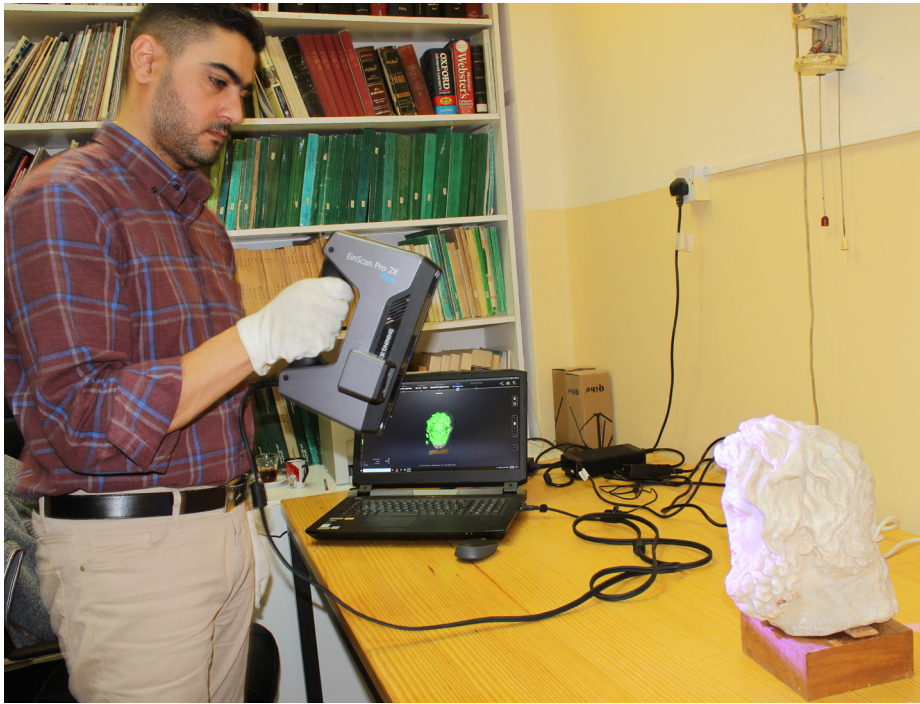
18 H. Khris beim 3D-Laserscanning eines römischen Marmorkopfes. (Foto: BAI Wuppertal/DEI Amman)
