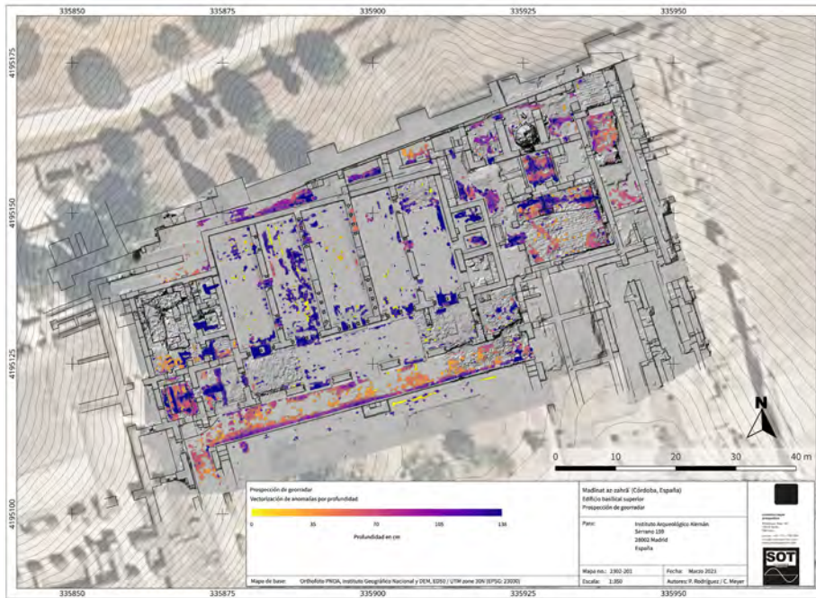
Abb. 8: Auswertung Georadar: Vektorisierung von Anomalien in verschiedenen Tiefen
