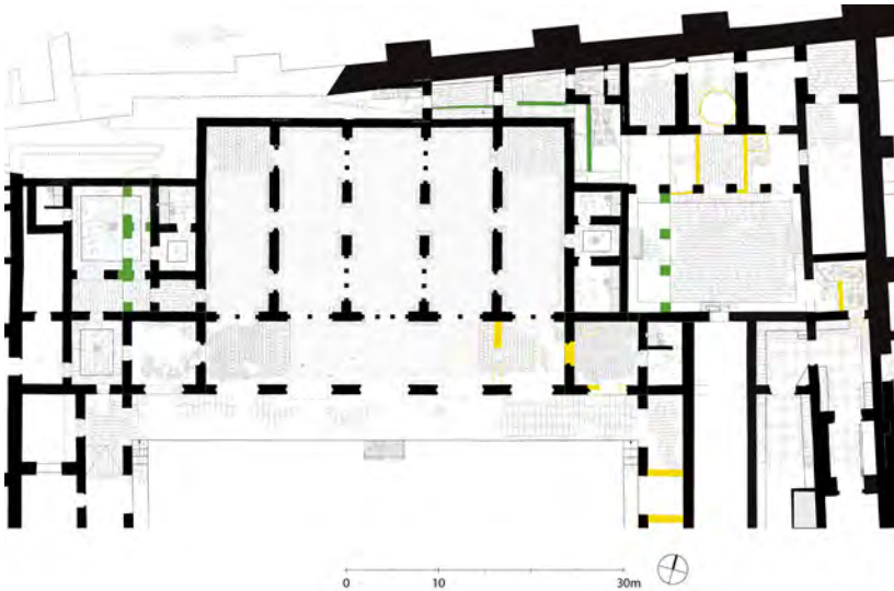
Abb. 22: Phasen 6 und 7, Untersuchungsbereich, Bauaufnahmeplan mit den letzten Umbauphasen: Einbau von Pfeilergalerien zur Erschließung des Obergeschosses über der Hoffassade des Oberen Saals (Phase 6: grün) und Unterteilungen und Einbauten für Nachnutzungen nach der Aufgabe der Kalifenresidenz (Phase 7: gelb)
