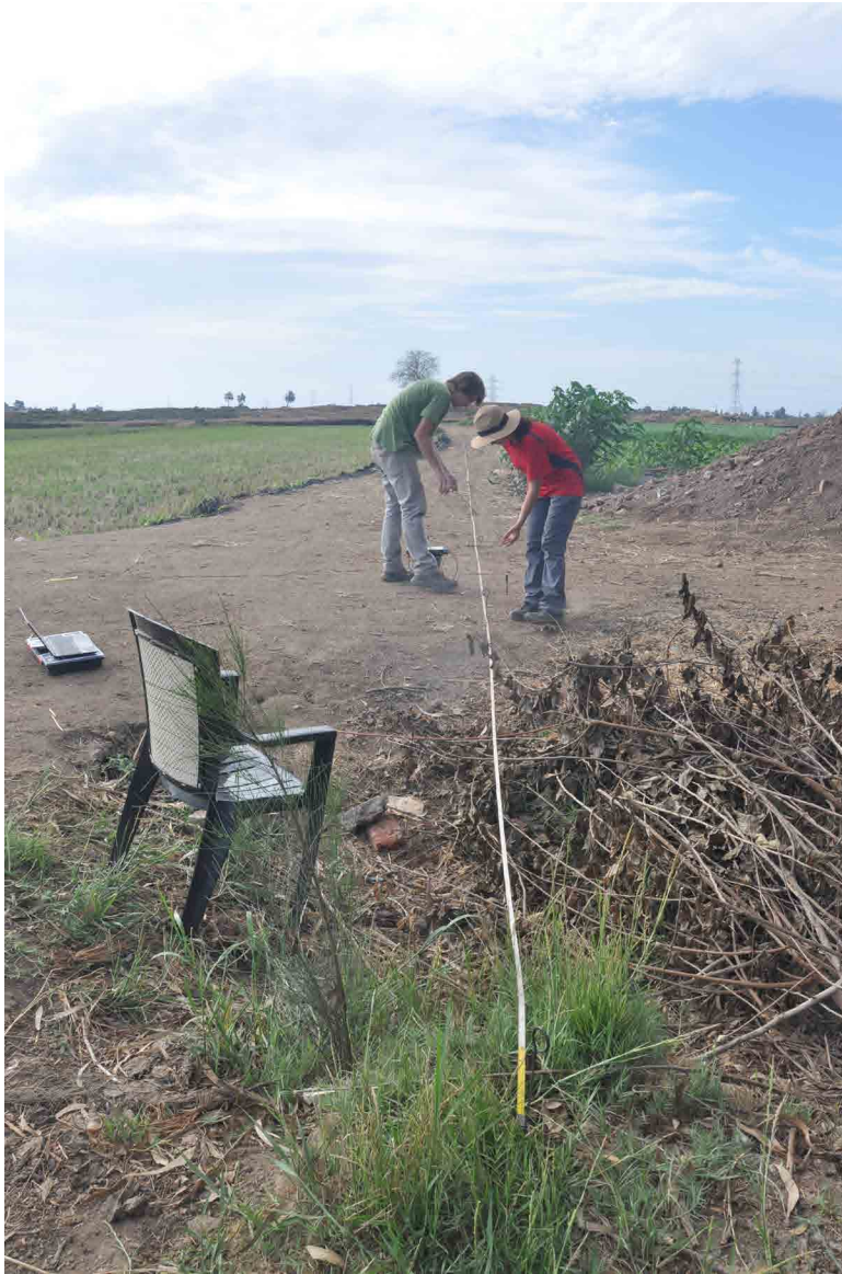
2 Gelände nördlich des Kom el-Gir. Elektrische Widerstandsmessungen. Die Reste des Siedlungshügels sind im Hintergrund als flach ansteigendes Gelände erkennbar. (Foto: R. Schiestl, DAI Kairo, LMU München)
