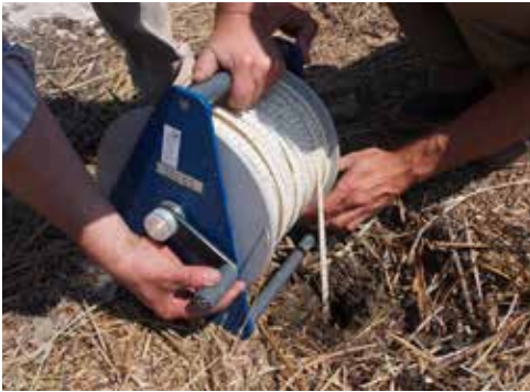
8 Bestimmung des Grundwasserstandes in einem Bohrloch mithilfe eines Kabellichtlotes (Foto: D-DAI-ATH- 2017-025082, J. Fuchs).
