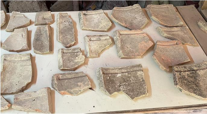
Abb. 9: Überblick über Unterziegel mit Falz
