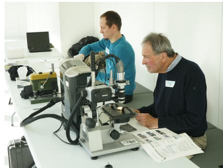
9 M. Bode (links) und A. Hauptmann (DBM) bei Detailaufnahmen von Verzierungen und gusstechnischen Details mit einem Keyence-Digitalmikroskop und bei der Probenbearbeitung. (Foto: A. Reinecke)
