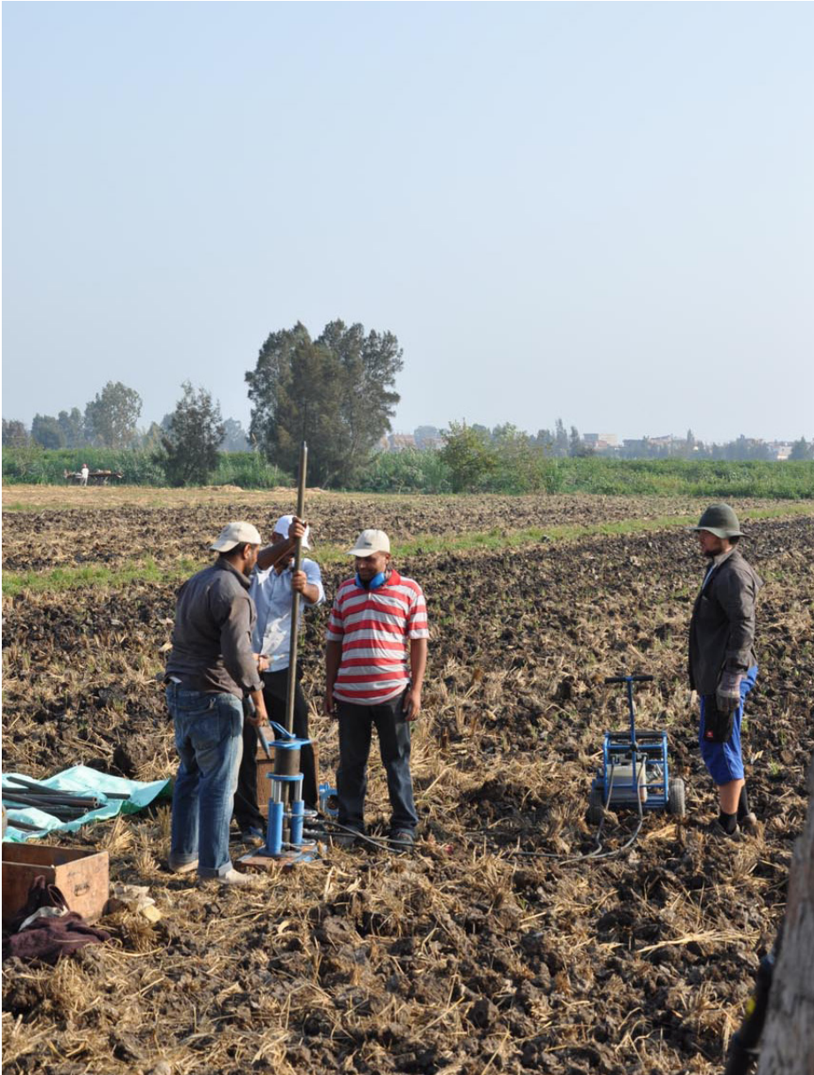
3 Herausziehen eines Bohrkerns aus dem insgesamt 12 m tiefen Bohrloch G26 mit Sedimenten eines verlandeten Nilarms (Foto: R. Schiestl).
