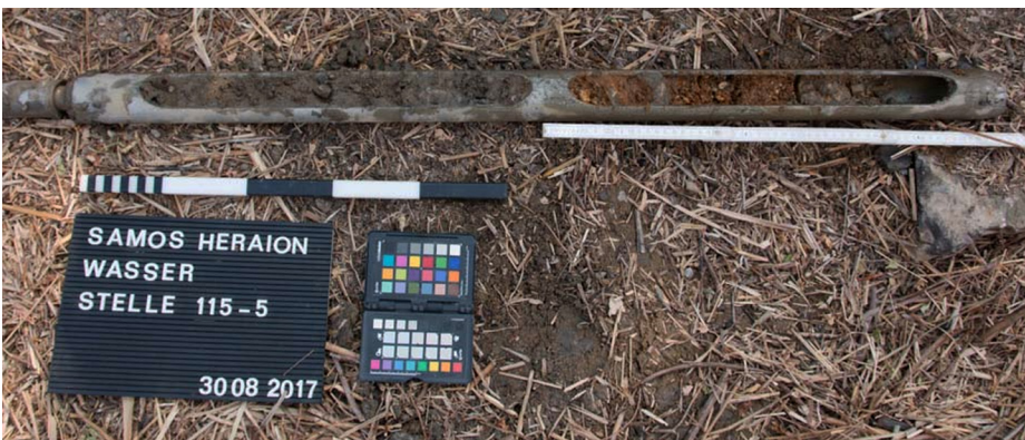
7 Bohrarbeiten im Südtemenos. Bohrhülse mit Bohrkern. Deutlich ist eine Abfolge von grauen Flutlehmschichten (links) und rötlichen Flusssedimenten (rechts) erkennbar (Foto D-DAI-ATH-2017-025041, J. Fuchs).
