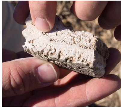
9 Sinterprobe von einer Tonrohrleitung im Bereich des Nordtores (Foto: D-DAI-ATH-2017-025498, J. Fuchs).
