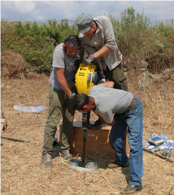
6 Bohrarbeiten nordwestlich des großen Tempels. Mithilfe eines Bohrhammers wird die Bohrhülse in den Boden getrieben (Foto: D-DAI-ATH-2017-024730, J. Fuchs).
