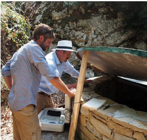
8 Bestimmung des Grundwasserstandes in einem Bohrloch mithilfe eines Kabellichtlotes (Foto: D-DAI-ATH- 2017-025082, J. Fuchs).
