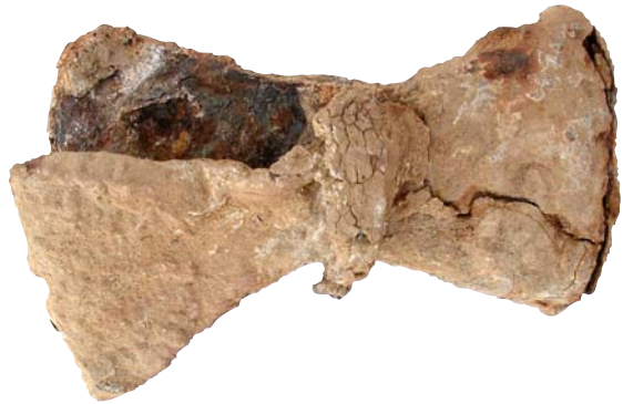
Abb. 24. Marib, Bau A, mit Blei ummantelte Eisenklammer; aus einer Cache im Auslassbereich.
