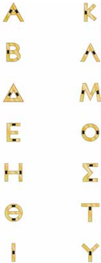
Abb. 20 Ermittelter Stifflochschema für die Inschrift des Architravs
