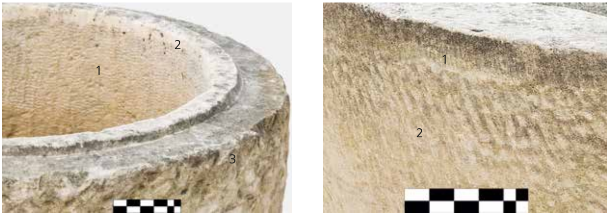
Abb. 5 a. Bearbeitungsspuren (OST 37) von Zahneisen (1), Glättung / Schmirgel (2) und grobem Spitzeisen (3). – b. Bearbeitungsspuren (OST 10) von Flacheisen (1) und Spitzeisen (2)
