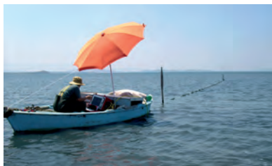
Abb. 61 Elaia, Geophysik. Geoelektrische Messung im Meeresbereich mit einem schwimmenden Elektrodenkabel
