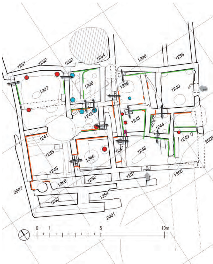
Abb. 35 a Hamadab, Nordhügel. Oberstadt, schematischer Grundriss der ausgegrabenen Areale in H 1200. Gefäße ohne Asche (blau), Gefäße mit Asche (rot), Lehmputz (grün), rötlicher Putz (orange), gelblicher Putz (gelb), Rinnsteine (pink). Doppelpfeile markieren wahrscheinliche Türdurchgänge, graue dicke Pfeile mögliche Hauseingänge (M. 1 : 150)
