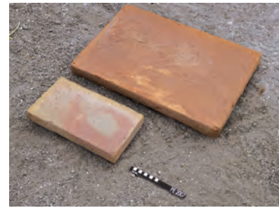
Abb. 62 Pergamon, Rote Halle. Die beiden für die Restaurierungsmaßnahme eigens hergestellten Ziegelformate
