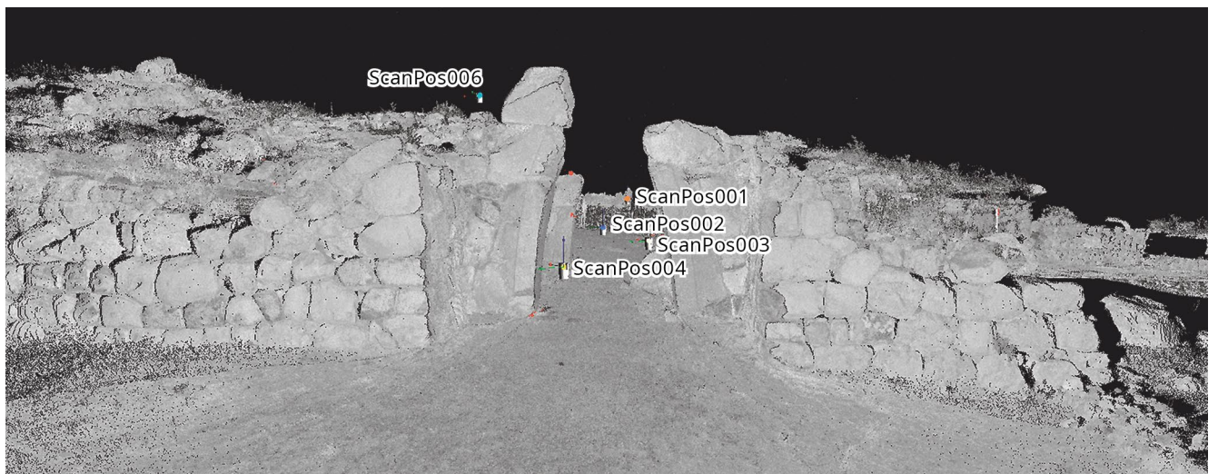
Abb. 76: Boğazköy-Hattuša, Außenfassade des Königstors. Vorläufiges Modell in Punktwolken (ohne Textur) mit Bestimmung der Scanpositionen
