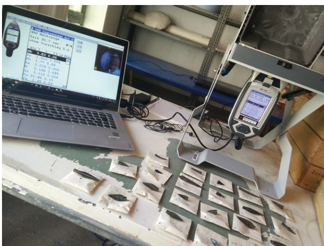
Abb. 26: Milet, Arbeitsfoto aus dem Kalabaktepe-Depot während der Ausführungen der Röntgenfluoreszenzanalyse mittels Niton XL3t
