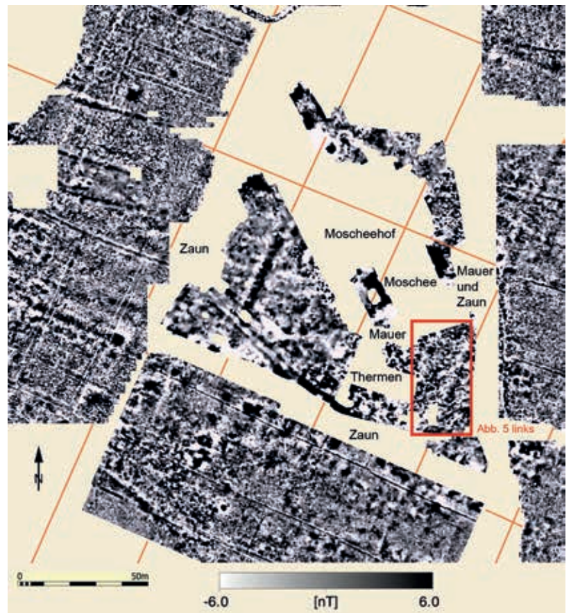
Abb. 4 Milet, Geomagnetik in der Umgebung der Südstadtthermen und Ilyas Bey-Moschee. Antike Straßen (mit hellroter Ergänzung des Rasters) zeichnen sich als dicke schwarze Linien ab, weil der meterhohe Belag aus relativ stark magnetisiertem Material wie Ziegelbruch besteht. Straßenrandbebauung aus nicht-magnetischem Kalkstein ist weiß. Der rote Rahmen bezeichnet den Ausschnitt in Abb. 5 links (M. 1 : 2000)
