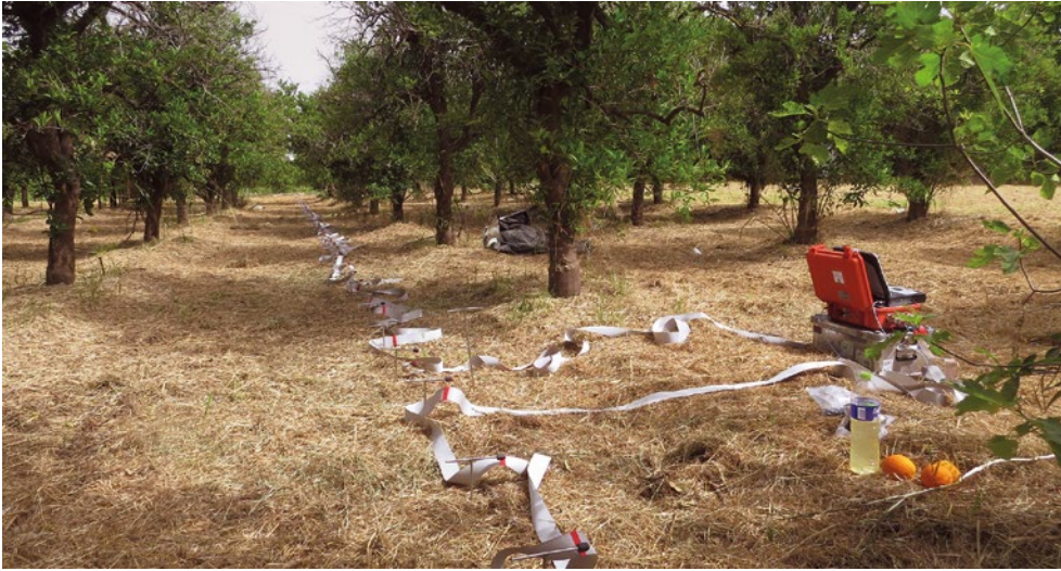
Abb. 143: Linienhafte Anordnung der Elektroden zur Messung der geoelektrischen 2D-Tomographie Tiryns 1 (100 Elektroden im Abstand 1 m, Lage s. Abb. 140)
