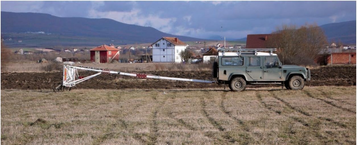
Abb. 2 Das fahrzeuggestützte Geomagnetik-Messsystem der Römisch-Germanischen Kommission während der Prospektionen in Gllamnik-Vindenis
