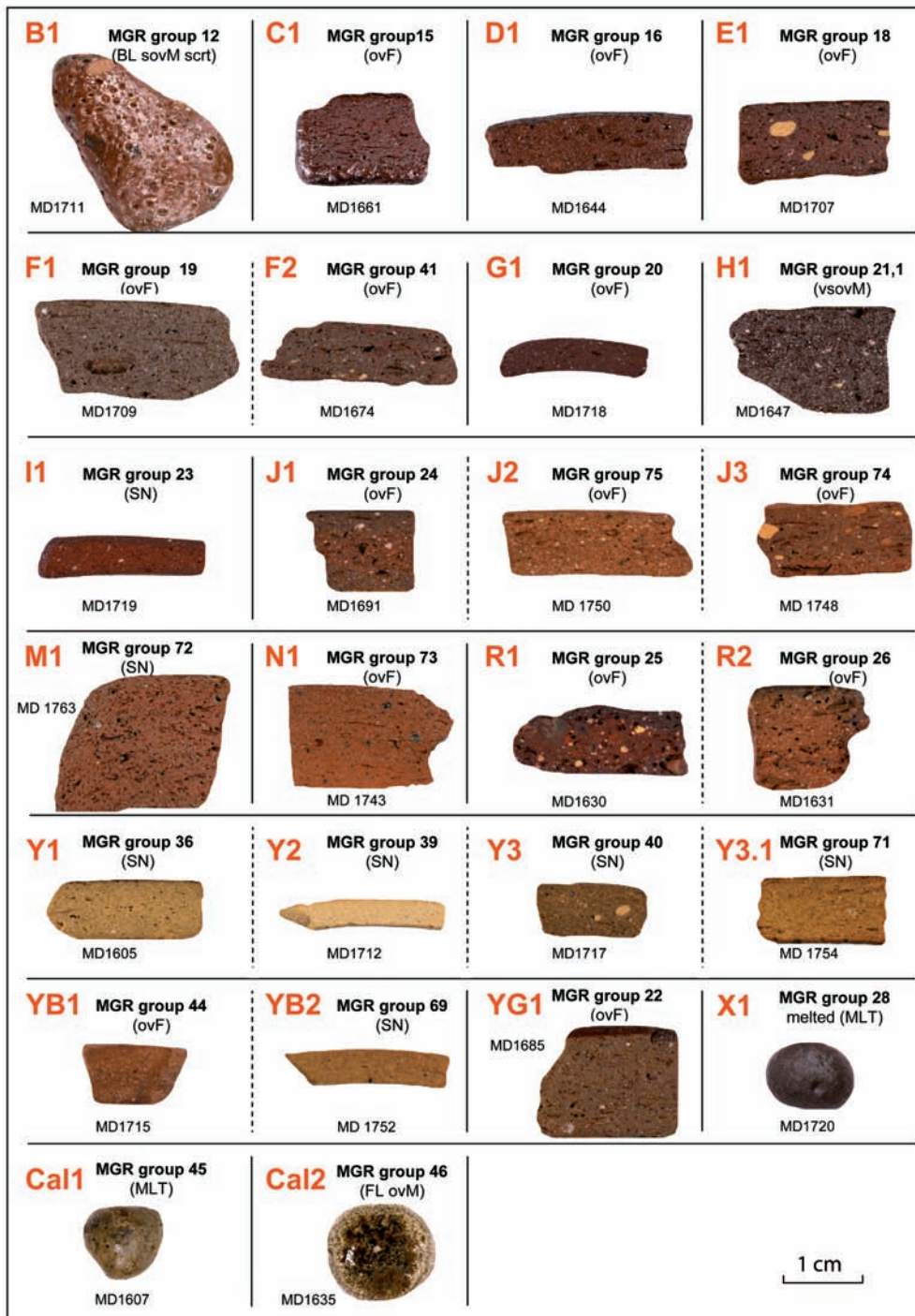
Abb. 5 Makrofotos von bei 1200 °C nachgebrannten Proben aus Meroë und Hamadab der Tontyp B–X und der Mergeltonne Cal1 und Cal2
