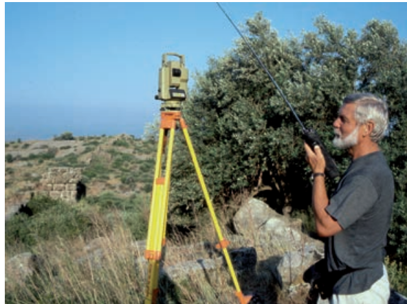
22 Der Einsatz modernster Vermessungsmethoden ermöglicht auch groß angelegte Bauaufnahmeprojekte, wie die Vermessung der Stadtmauer von Stratos. Der Geodät des Architekturreferates Ulrich Kapp bei der tachymetrischen Vermessung
