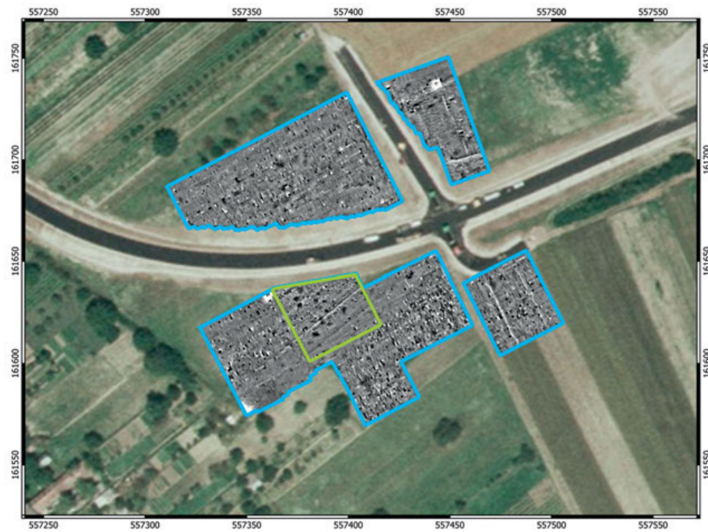
Abb. 3. Szólád. Die Messung 2005 mit einer Dynamik von \pm 10 nT eingefügt in das Orthofoto von 2005.
